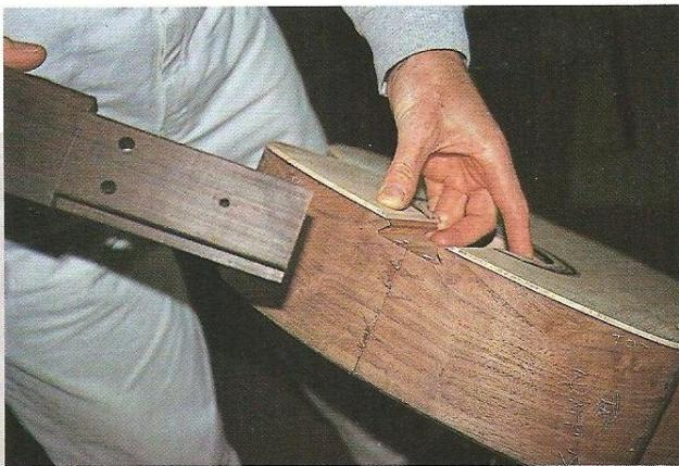
アコースティックのネック・ジョイント部。ネック側とブロック側の溝がスライド式に差し込まれるユニークなデザイン。経年による強度変化もあまり無く、非常に強固なジョイントが可能。また従来のジョイントに比べネックの着脱が容易なため、リペア面でも合理的な設計。
