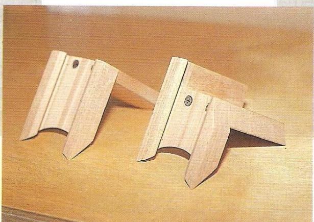
L字型になっているネック・ブロック。右はカッタウェイ用、左はノンカッタウェイ用だ。ネックを差し込むための溝が付けられ、この溝にネックがきっちりとジョイントすることになる。
