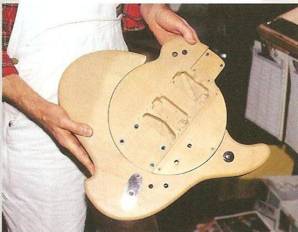
ギター・デザインと、その演奏性、ホールド性を実験するために作られたユニークな実験用ボディ。中央のP.U.、ネックをセットする円盤は回転させることができ、どのような角度でセットするのか望ましいかを手軽に試すことができる。クラインではこのような実験が常に行なわれ、ギターがデザインされている。
