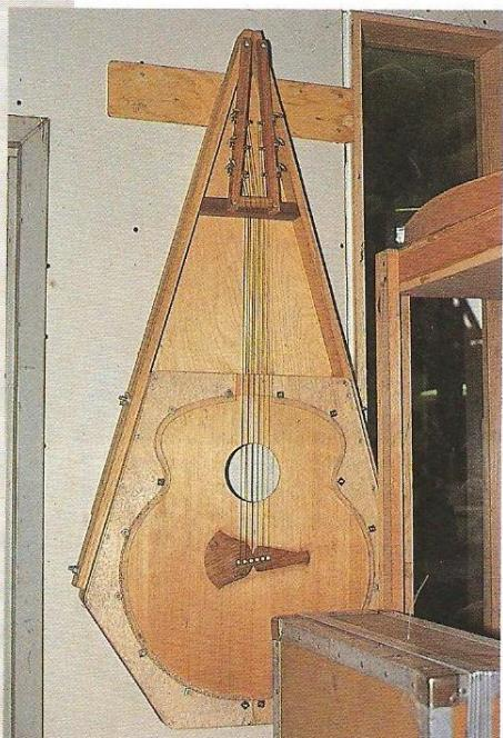
これがスゴイ！　自作ボディ・トップの構造実験装置。ボディ・トップにブリッジやブレイスを取り付け、この装置にセッティングすることによりトップの音響特性をチェックすることができる。クライン氏は、この実験装置を使いトップとブレイシング、ブリッジとの関係を研究した。初期に製作したアコースティックの数10本はこれを使っていたが、現在はあまり使用していない。
